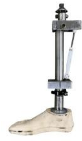
Gambar 2. Sendi lutut single axis dengan mekanisme brake control (desain prototype ).
